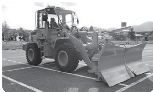
▲除雪ドーザー
